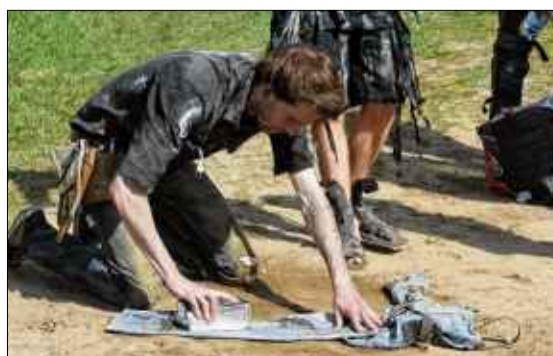
So entsteht der Used Look: Auf dem Boden wird die Jeans mit einer Käseprobe aufgeraut.
